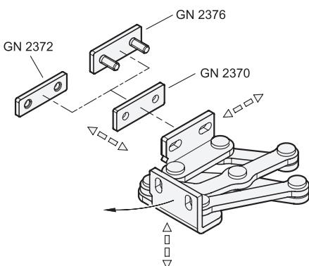
Die Edelstahl-Mehrgelenkscharniere lassen sich bei der Montage in drei Ebenen justieren. So können z. B. Toleranzen ausgeglichen oder benötigte Anpressdrücke für Dichtungen eingestellt werden.
